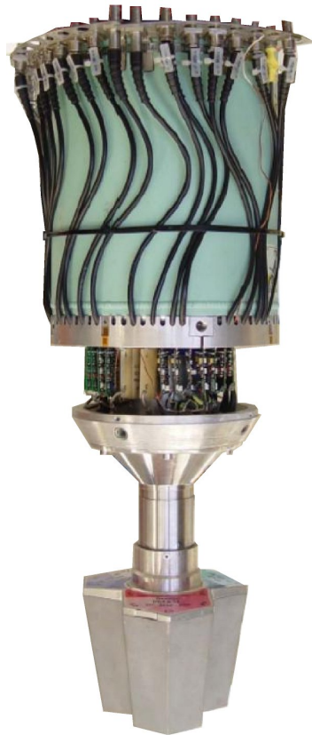
Abbildung 3.2: Ein einzelner MINIBALL Triple-Cluster besteht aus drei einzelnen hochreinen Germanium-Kristallen (unten), die von einem LN 2 -Dewar (oben) versorgt werden. Der nicht gekühlte Vorverstärkerbereich (mittig) ist nicht abgedeckt zu Präsentationszwecken (Abbildung aus [67]).
