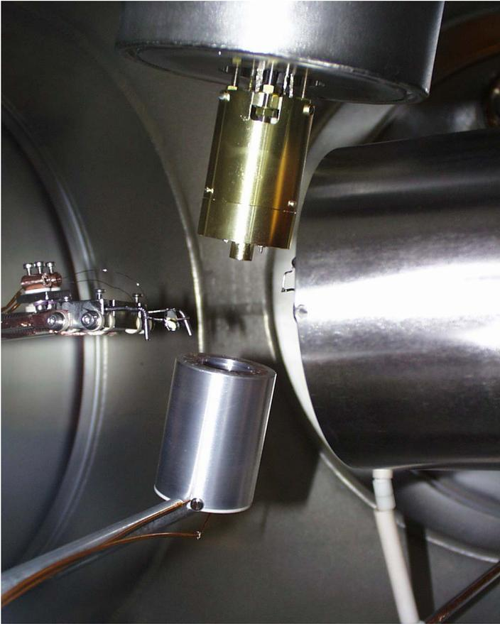
**Abbildung 3.4.** Blick in die Targetkammer. Links ist der Diamant auf dem Manipulator zu erkennen. Von oben wird die Elektronenkanone mit ihrer Abschirmung eingeführt. Gegenüber sitzt der abgeschirmte Faradaycup. Am rechten Bildrand ist die Abschirmung der Ionenoptik erkennbar
