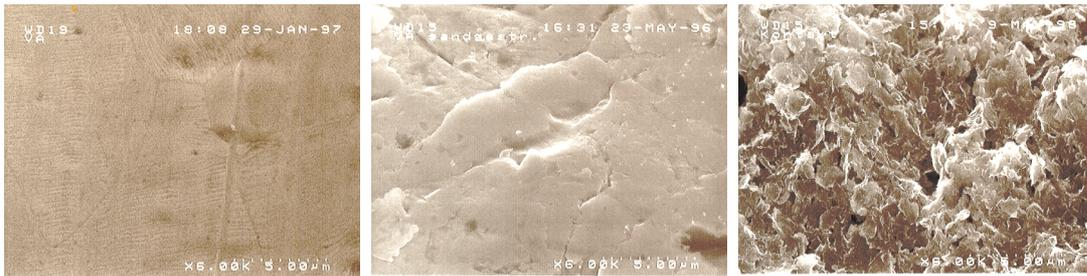
Abbildung 3.8: Mikrostruktur der sehr unterschiedlichen Substratoberflächen. Die Aufnahmen wurden mit einem Sekundärelektronenmikroskop (SEM) gemacht und zeigen einen Ausschnitt der Breite  $20\ \mu\text{m}$ . Hier lassen sich die Oberflächen von poliertem Edelstahl (links), Edelstahl sandgestrahlt (mitte) und einer RSG-Schicht (rechts) gut vergleichen.
