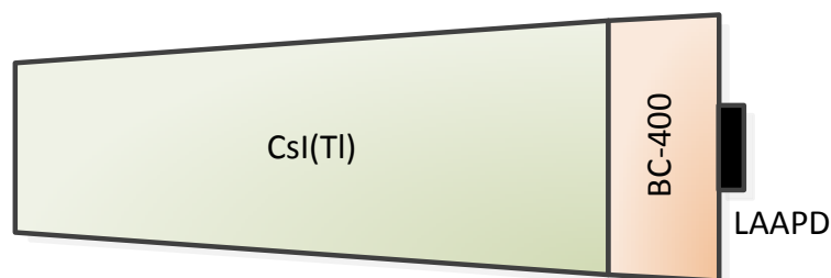
Abbildung 4.4.: Phoswich Detektor (Ansicht von oben)
