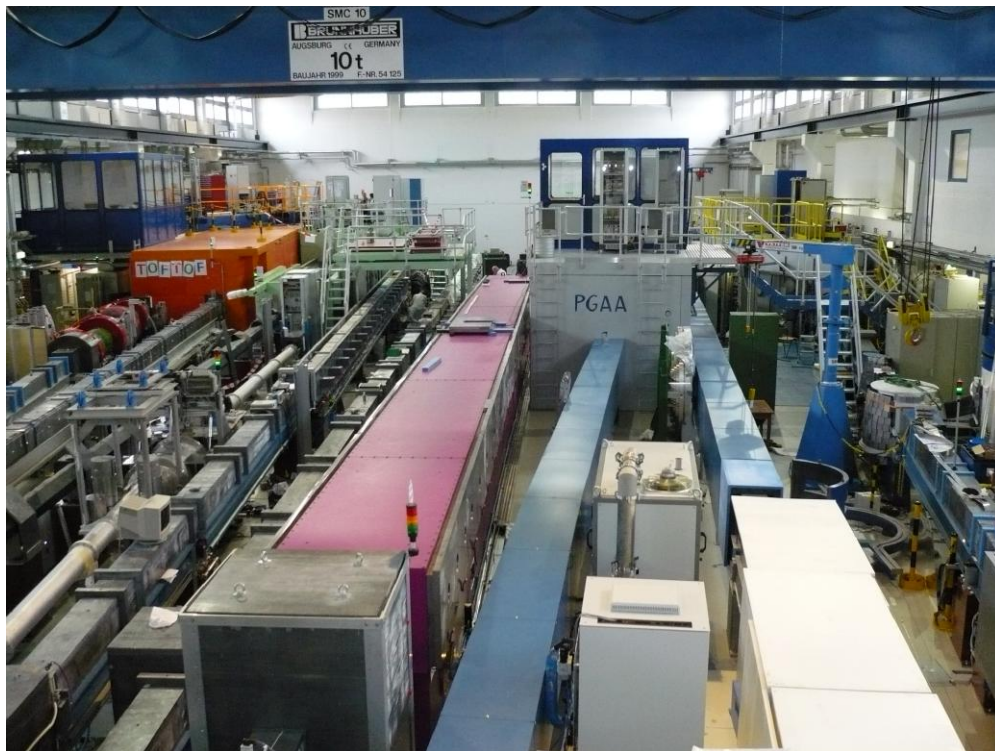
Abbildung 3.6.: PGAA-Messstation aus der Sicht des Reaktorkernes. Die Krümmung des Neutronenleiters (blaue Bahn) ist sehr gut zu erkennen. Die annähernd parallelen Bahnen sind ebenfalls Neutronenleiterbahnen, die Neutronen zu anderen Experimenten führen.
