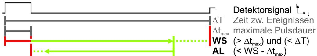
Abbildung 2.7: Bedingungen an die Parameter des MWD-Algorithmus.
