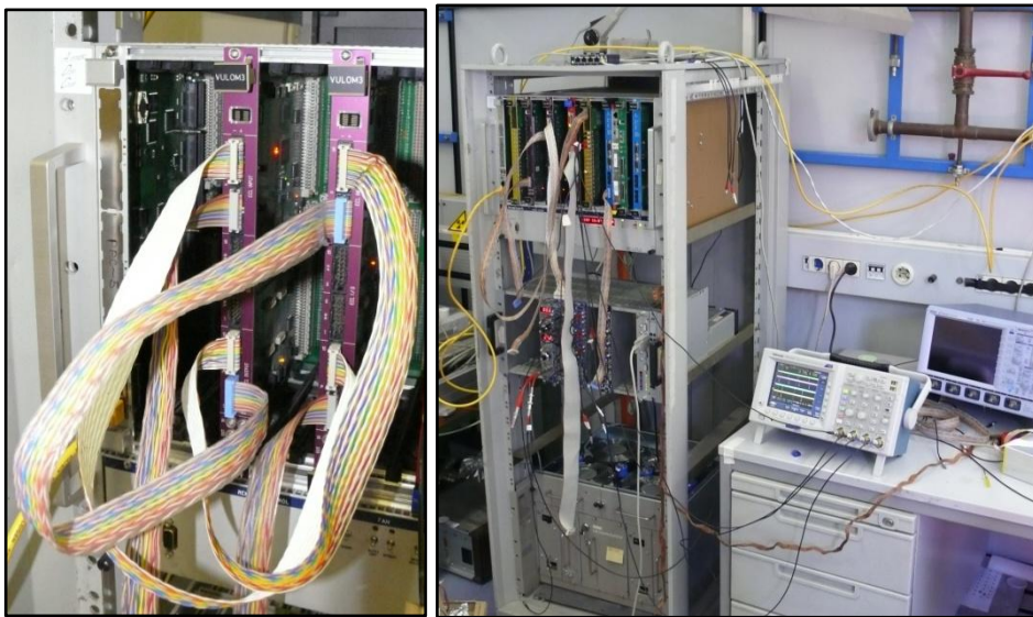
Abbildungen 5 und 6: Links die Module am VME-Bus, rechts ein Test-Aufbau mit Oszilloskop.
