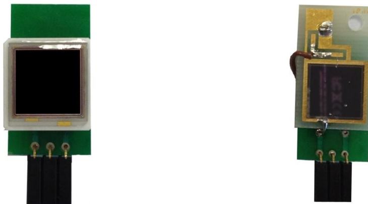
Abbildung 30: APD S8664-1010 von Hamamatsu (links) und eine PIN-Diode (rechts)
