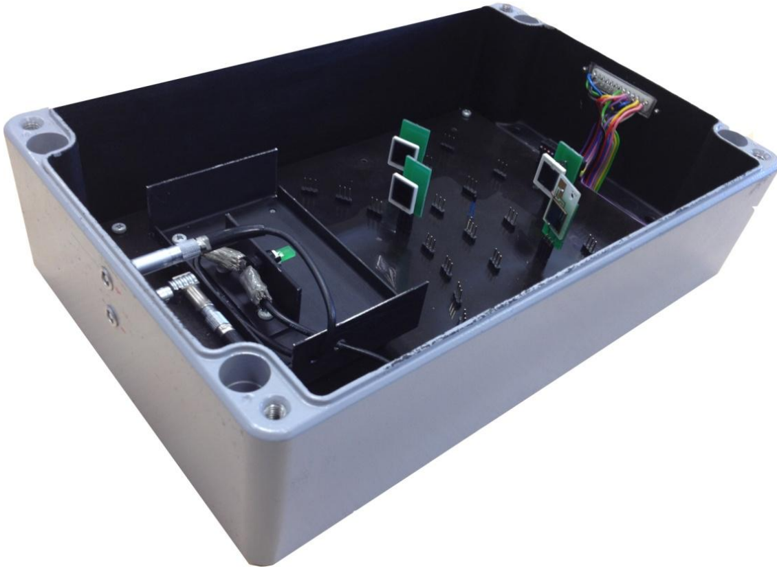
Abbildung 9: Das Messgehäuse aus massivem Aluminium mit Abschirmdose für die LED
