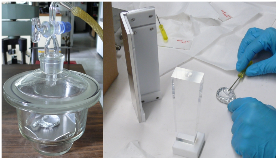
Abbildung 3.10.: Links: Evakuieren des angemischten Klebers unter Verwendung einer mechanischen Pumpe. Rechts: Auftragen des Klebers auf einen Plexiglas-Formmuster
