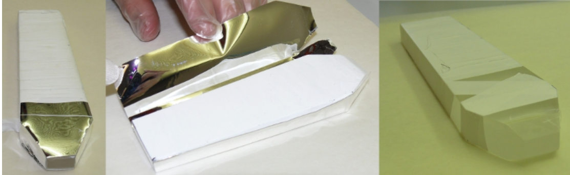
Abbildung 3.4.: Auswickeln des Prototypen von der USC, von links nach rechts die drei Schichten des Wrappings: äußeres Teflon, ESR, innere Teflonschicht
