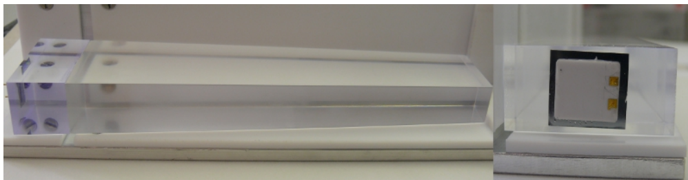
Abbildung 2.3.: Links: Fertiger Phoswich-Detektor in Seitenansicht (der kurze Plastiksintilliator befindet sich auf der linken Seite, der lange CsI(Tl)-Kristall rechts). Rechts: Auf dem Plastiksintillator befestigte APD
