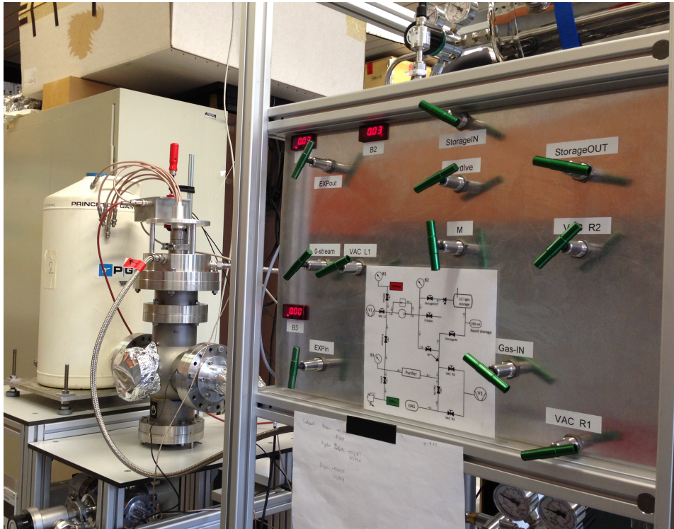
Abbildung 3.1: Dewar (links), Isoliergehäuse (Mitte), Ventile des Gassystems(rechts)
