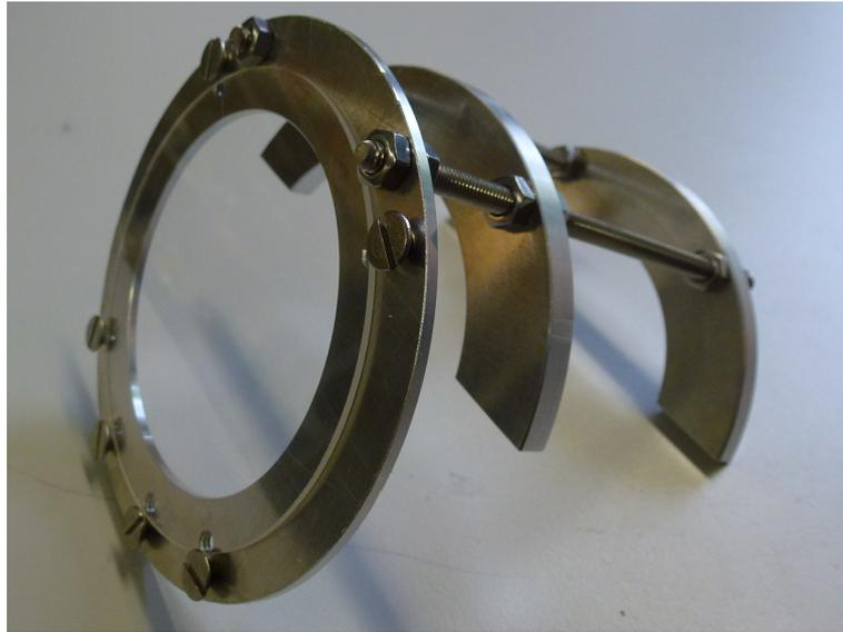
ABBILDUNG 4.8: Glasplattenhalter mit eingebauter Quarzglasscheibe.
